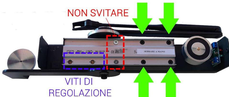
Figura 15 - Viti interne al Master White (svitare solo le 4 di colore NERO indicate dalla frecce verdi mentre le viti argento zincate non devono essere svitate) modelli NC/A e NL/A
