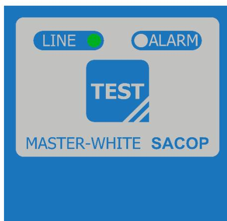
Figura 47 - Accensione led VERDE LINE che indica la corretta alimentazione del Master White
