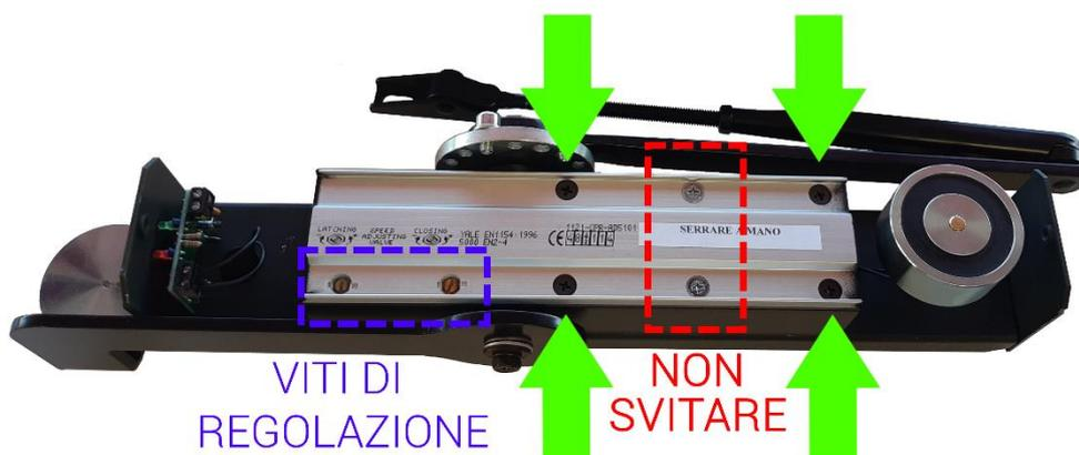
Figura 33 - Viti interne al Master White (svitare solo le 4 di colore NERO indicate dalla frecce verdi mentre le viti argento zincate non devono essere svitate) modello NL-A/C
