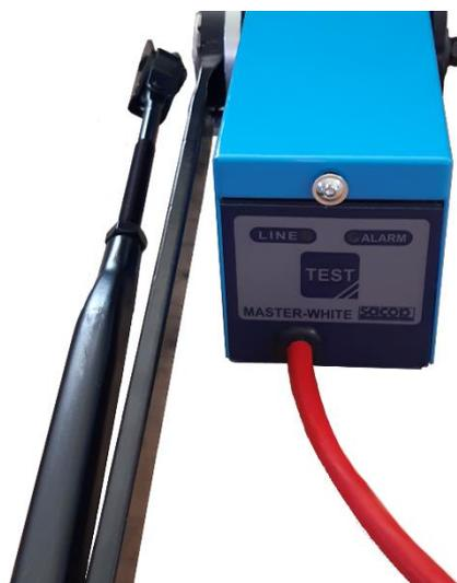
Figura 38 - Collegamento alimentazione elettrica con il Master White chiuso
