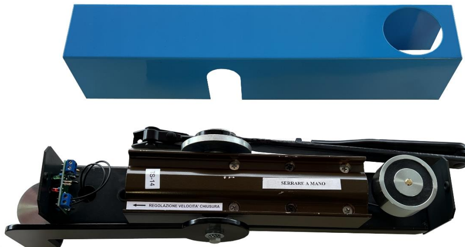
Figura 30 - Master White con carter esterno smontato modello NL-A/C
