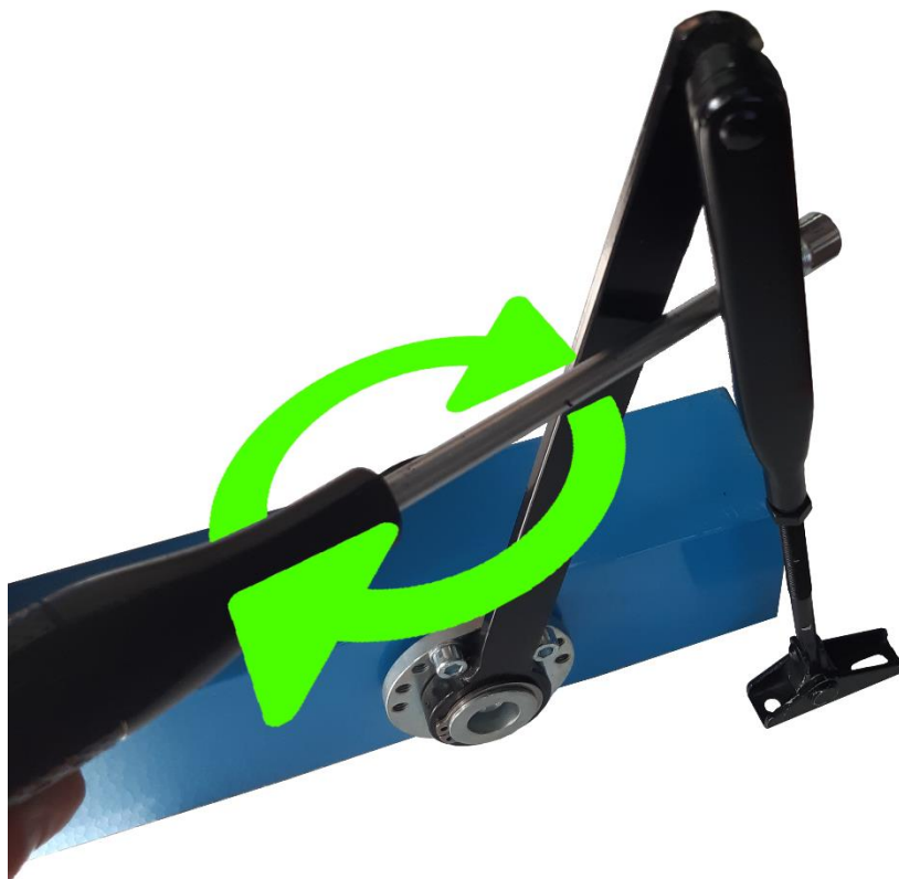
Figura 27 - Rotazione del cacciavite per sganciare il perno del braccetto
