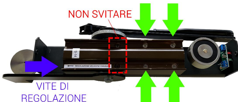
Figura 15 - Viti interne al Master White (svitare solo le 4 di colore ARGENTO zincate indicate dalla frecce verdi mentre le viti nere non devono essere svitate) modelli NC/A e NL/A
