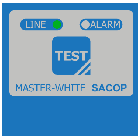
Figura 43 - Accensione led VERDE LINE che indica la corretta alimentazione del Master White
