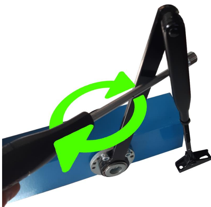
Figura 42 - Rotazione del cacciavite per sganciare il perno del braccetto
