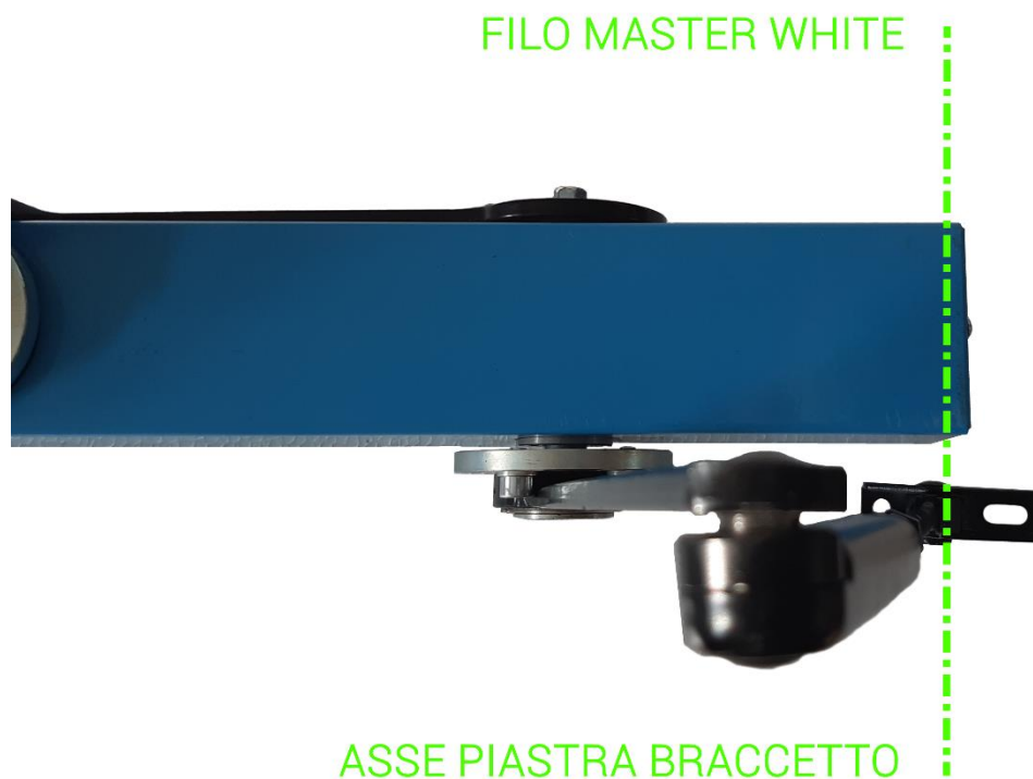
Figura 23 - Posizionamento dell'asse della piastra di ancoraggio del braccetto in linea con il filo del Master White (vista dall'alto)
