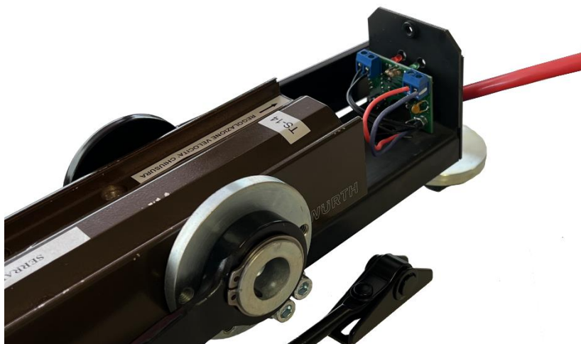
Figura 35 - Collegamento alimentazione elettrica con il Master White aperto
