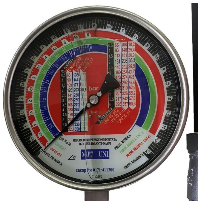
Figura 4 - Manometro di precisione con fondo scala 12 bar
